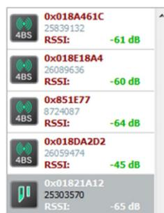
Die Registerkarte „Eingänge“ zeigt die EnOcean Telegramme, die in BACnet-Datenpunkte umgewandelt werden. Um Datenpunkte zu erzeugen, muss das Gateway die ID und das EEP des Sensors kennen, da dieses definiert, wie welcher Datenpunkt erzeugt wird. Daher können nur EnOcean Sensoren, deren EEP anhand des Lerntelegramms erkannt oder denen ein EPP manuell zugewiesen wurde, zugeordnet werden.
