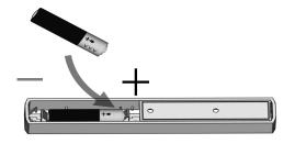
Batterie in Halterung einsetzen.
